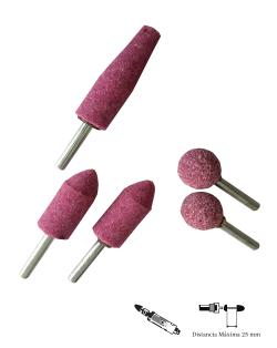
CARACTERÍSTICAS: Fabricadas en óxido de Aluminio rosado con ligas vitrificadas que operan a 33 mts por segundo. Se fabrican con ejes de 1/4 y 1/8 de pulgada.
